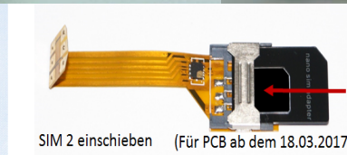
SIM 2 einschieben (Für PCB ab dem 18.03.2017)
